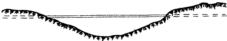
Рис. I2. Однопролетный прямолинейный бескомпенсаторный переход
