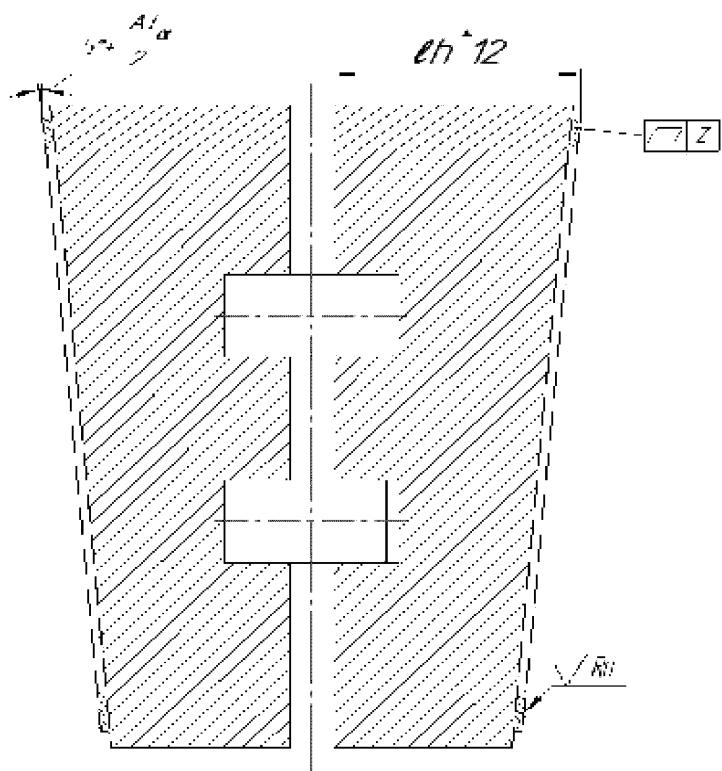
\* Размер рассчитывается из условия обеспечения гарантированного контакта уплотнительной поверхности клина по периметру уплотнительной поверхности седла корпуса при закрытом затворе с учетом ширины уплотнительных поверхностей и допусков на линейные размеры клина и седла корпуса.
