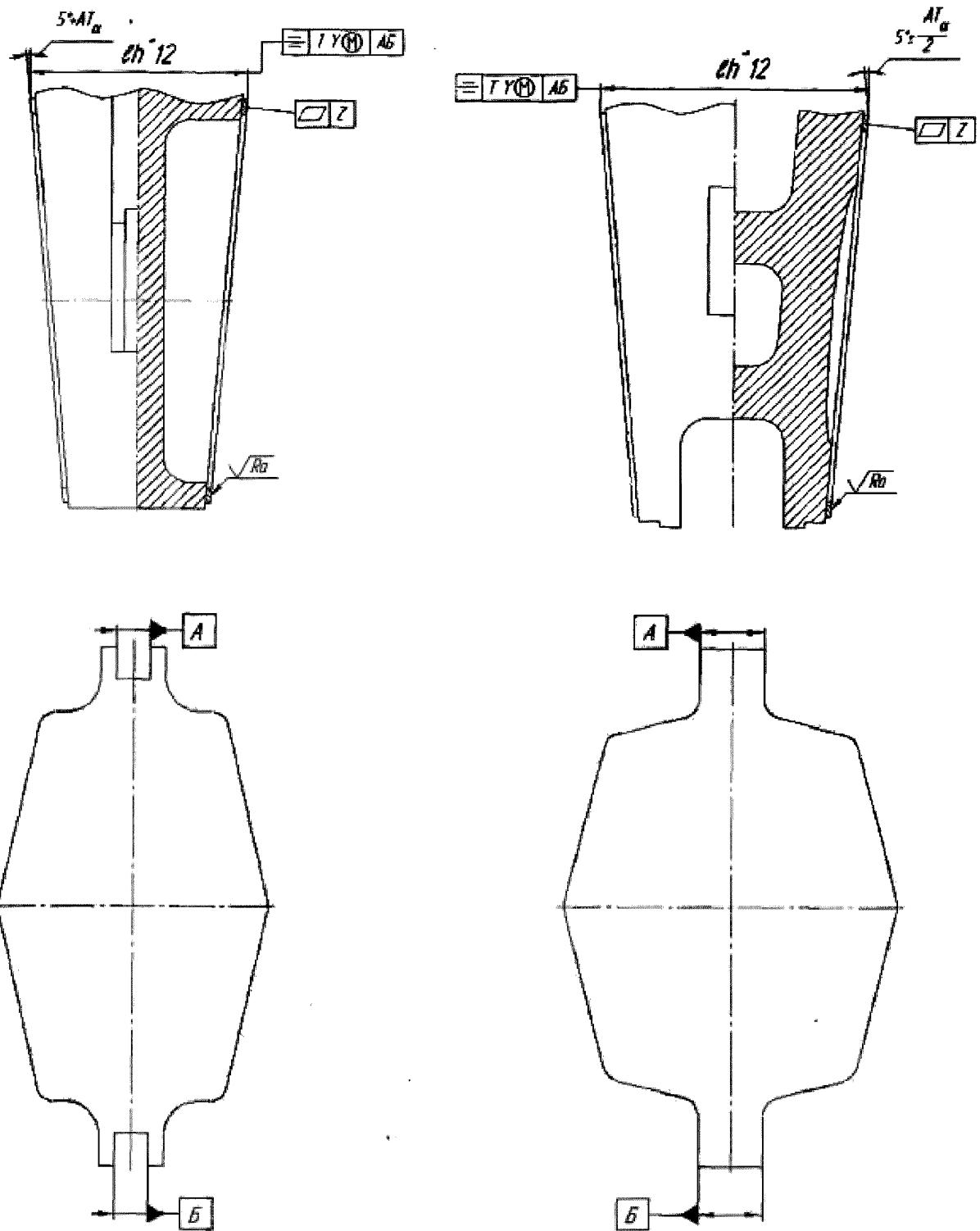
\* Размер рассчитывается из условия обеспечения гарантированного контакта уплотнительной поверхности клина по периметру уплотнительной поверхности седла корпуса при закрытом затворе с учетом ширины уплотнительных поверхностей и допусков на линейные размеры клина и седла корпуса.
