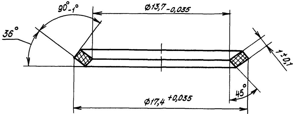
3. Материал: заготовки из фторопласта-4 по ТУ 6-05-810-76; материал заготовки Ф-4, сорт 1 ГОСТ 10007-72.
