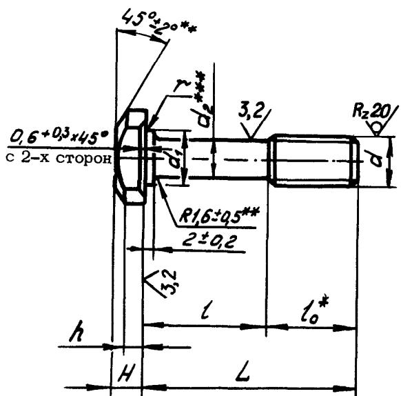
6,3 ✓ (✓) - при изготовлении болта из калиброванного прутка точением
