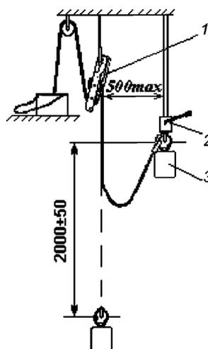
схема испытания УКСПр при закреплении тормозного устройства на стенде
