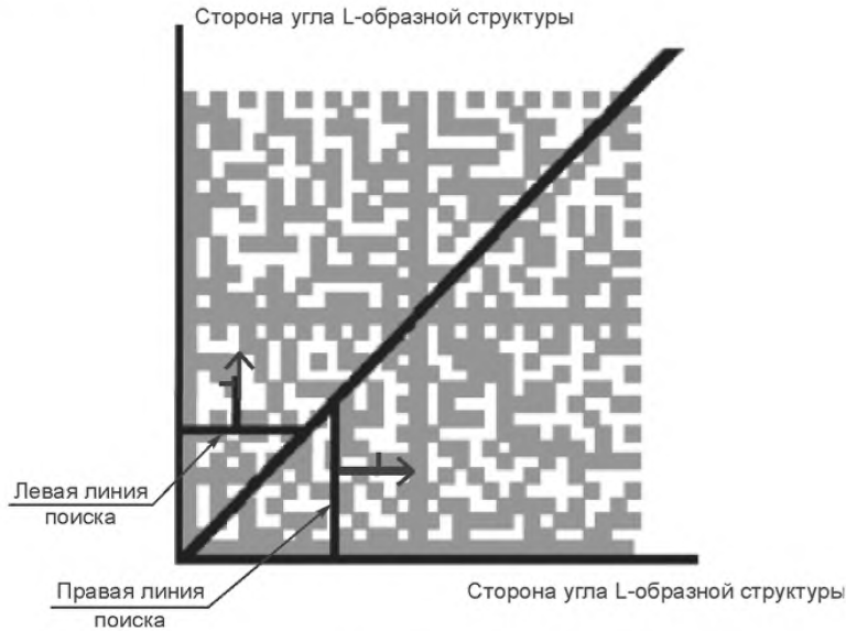
Рисунок 9 — Направления движения линий поиска
