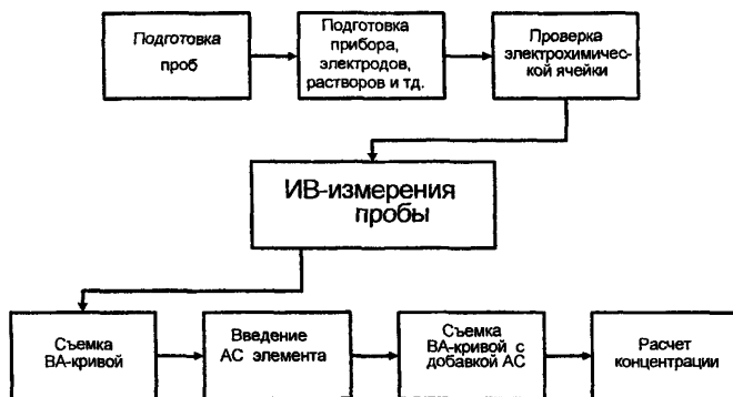
Рисунок 1. Основные этапы анализа проб методом ИВ
