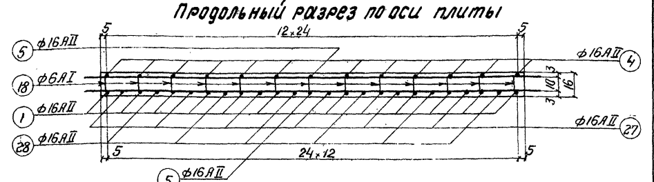
Спецификация арматуры на одну плиту П-III; П-IV; П-V
