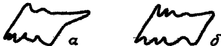
Рис.3. Динамограммы работы штанговых насосов в скважине 2455 в ЦДНГ № 8 НГДУ "Лениннефть": а) после спуска насоса; б) перед подъемом.
