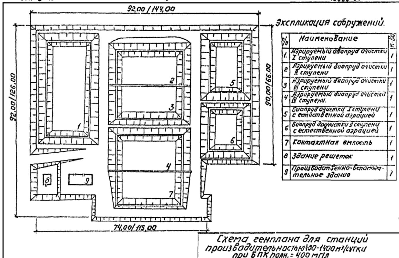
При механической аэрации в биопруде устанавливаются механические аэраторы (I-2 единицы), при пневматической аэрации по дну пруда, в каждой ступени, равномерно укладываются перфорированные трубопроводы, в направлении, перпендикулярном направлению движения воды.
