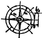
Плавающий механический аэратор состоит из понтона, привода аэратора и рабочего органа
