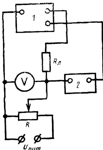
$R_{л}$  — резистор, имитирующий сопротивление линии;  $R$  — регулировочное сопротивление;  $U_{пит}$  — напряжение питания логометра;  $V$  — вольтметр, контролирующий напряжение питания; 1 — поверяемый логометр; 2 — образцовый магазин сопротивления.
