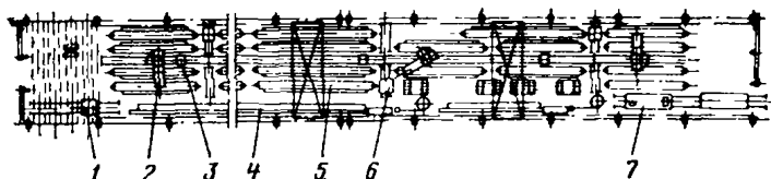
Рис. 30. Технологическая линия изготовления преднапряженных длинномерных конструкций в силовых формах
