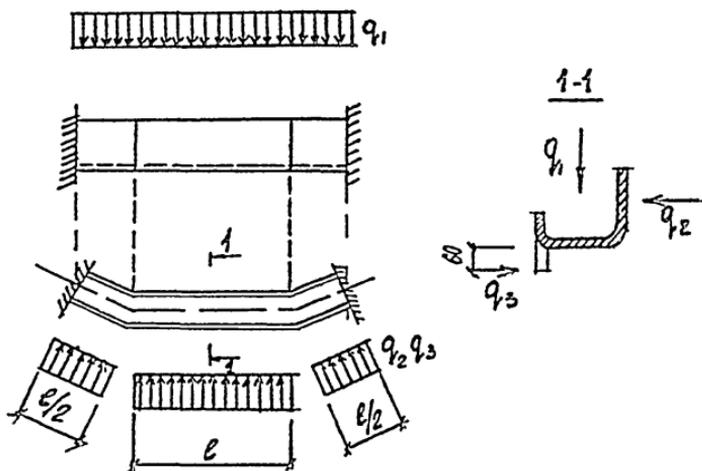
РАСЧЕТНЫЕ НАГРУЗКИ НА ЛОТКИ
