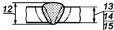
б) стыковой шов с полным проплавлением Full penetration butt weld Soudure à pleine pénétration
