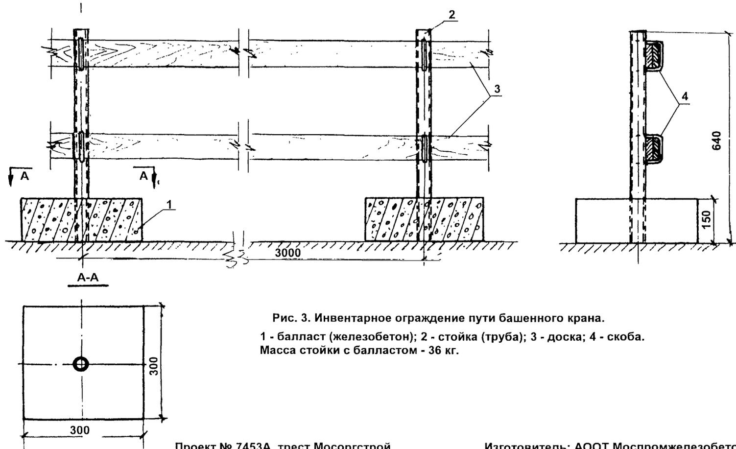
Рис. 3. Инвентарное ограждение пути башенного крана.
