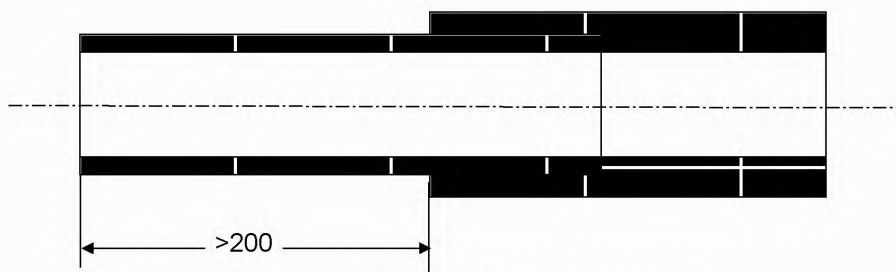
Рис. 8. Контрольное сварное соединение типа Р.
