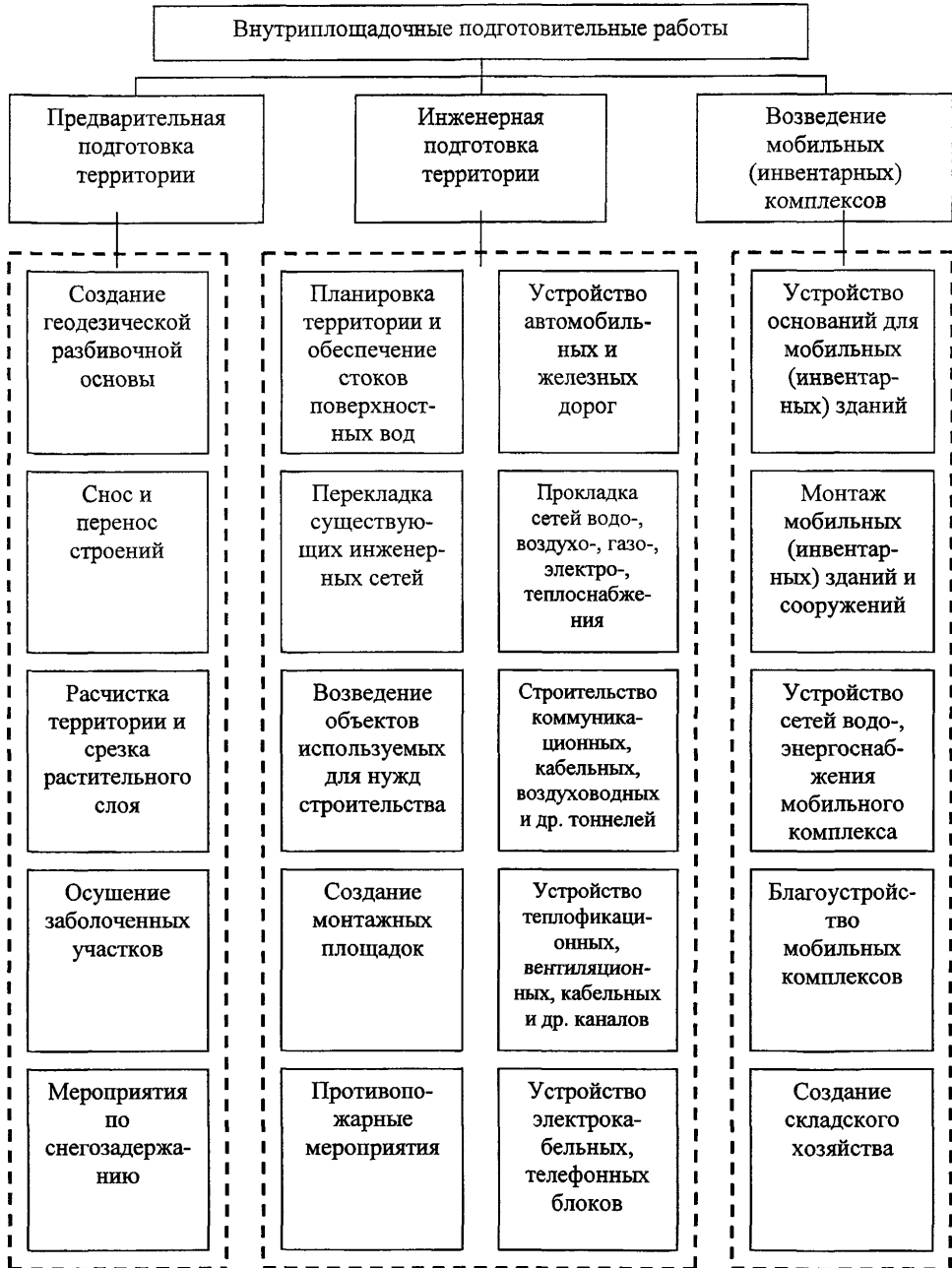
Рис. 1. Состав внутриплощадочных подготовительных работ
