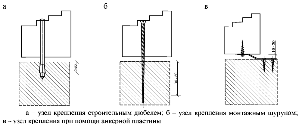
Рисунок 4 – Примеры крепежных узлов
