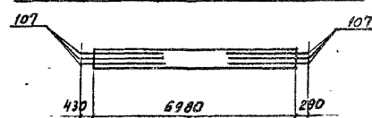
Схематический план расположения арматурных выпусков
