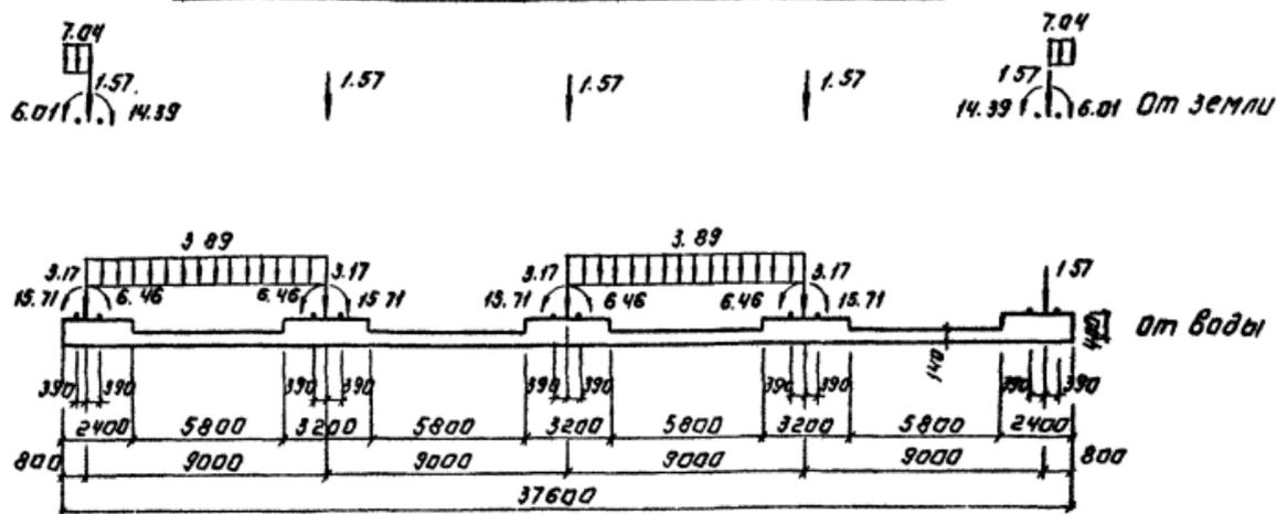
Средоточенные нагрузки в тс; средоточенные моменты в тсм;
