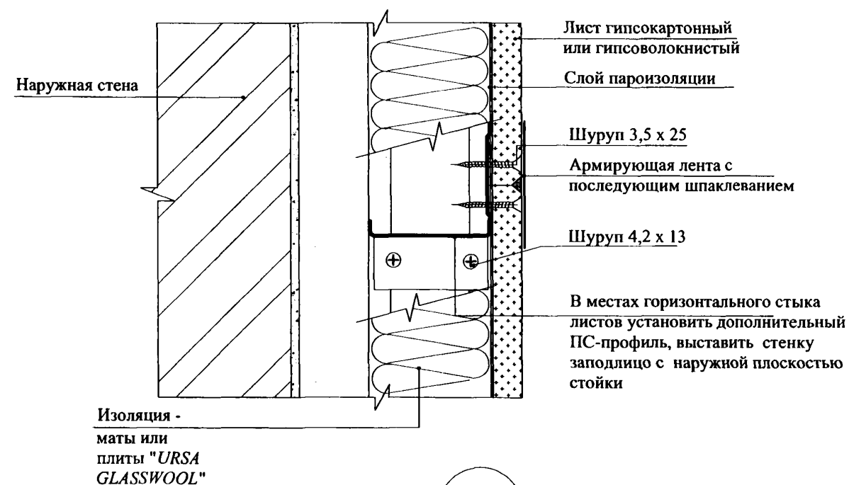
Горизонтальный стык двухслойной обшивки
