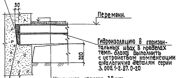
Деталь гидроизоляции анища при грунтовых водах
