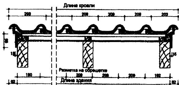
Рис. 9. Продольный разрез кровли с применением на фронтоне боковой черепицы (левой и правой)
