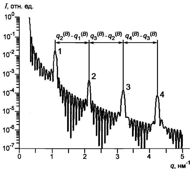
$q_1^{(B)}, q_2^{(B)}, q_3^{(B)}, q_4^{(B)}$  — значения в единицах модуля вектора рассеяния угловых координат брэгговских пиков кривой рассеяния с порядковыми номерами 1, 2, 3 и 4 соответственно. Стрелками указаны одинаковые угловые расстояния между брэгговскими пиками, равные  $2\pi/d$ , где  $d$  — значение периода повторения слоев в пленке, нм. Между брэгговскими пиками расположены эквидистантные осцилляции Киссига.
