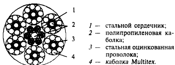
Рисунок В.1 — Канат типа ПОЛИСТАРК и ПОЛИСТАРК Супер 6-прядные (ТУ 8121-001-49718938-2002)
