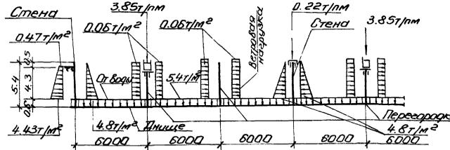
Нормативная нагрузка на поверхности грунта принята  $1 \text{ т/м}^2$ . Ветровая нагрузка принята по III ветровому району (СНиП II-V.1-62).
