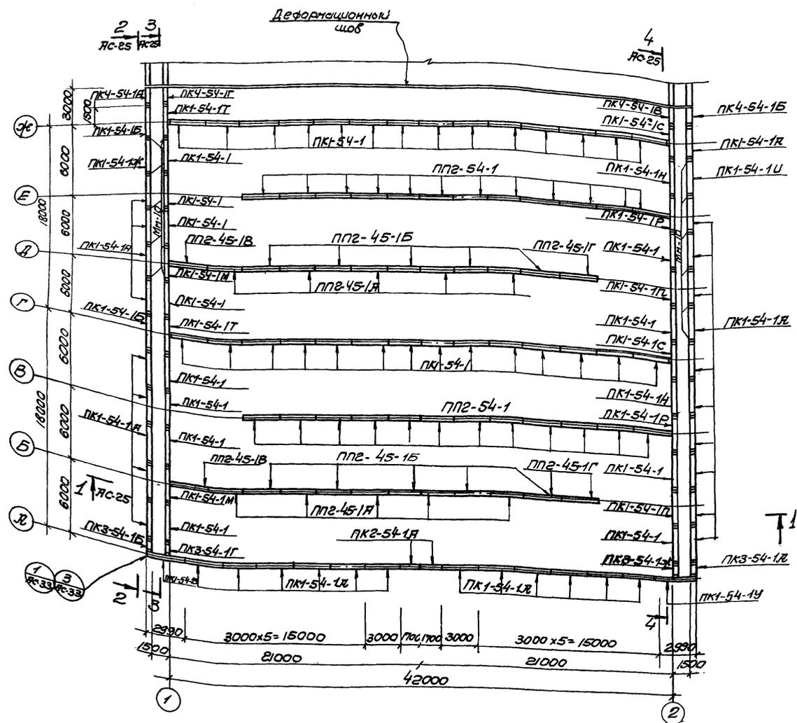
Монтажный план стеновых панелей
