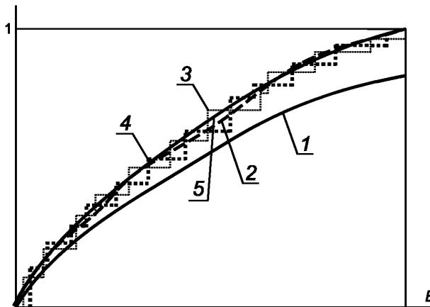
1 — функция распределения наработки изделий до отказа  $F(t)$  на интервале  $(0, b)$ ; 2 — функция  $F_0(t)$ ; 3 и 4 — две ступенчатые функции  $F_{0S}(t)$ , соответствующие двум разным способам классификации ИПД; 5 — аппроксимирующая функция  $F_{0A}(t)$ .
