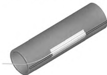
Рисунок 8 — Датчик ограничителя температуры на поверхности электронагревателя
