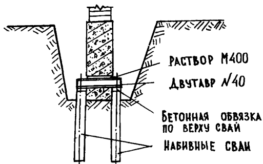
Рис. 5. Пересадка существующих фундаментов на сваи
