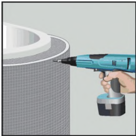
Рисунок 11.2. Устройство скругленного фартука ванны
