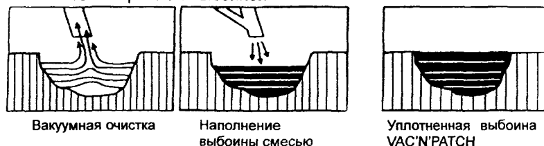
Рис 7.7. Схема заделки выбоин по вакуумно-струйно-инъекционной технологии
