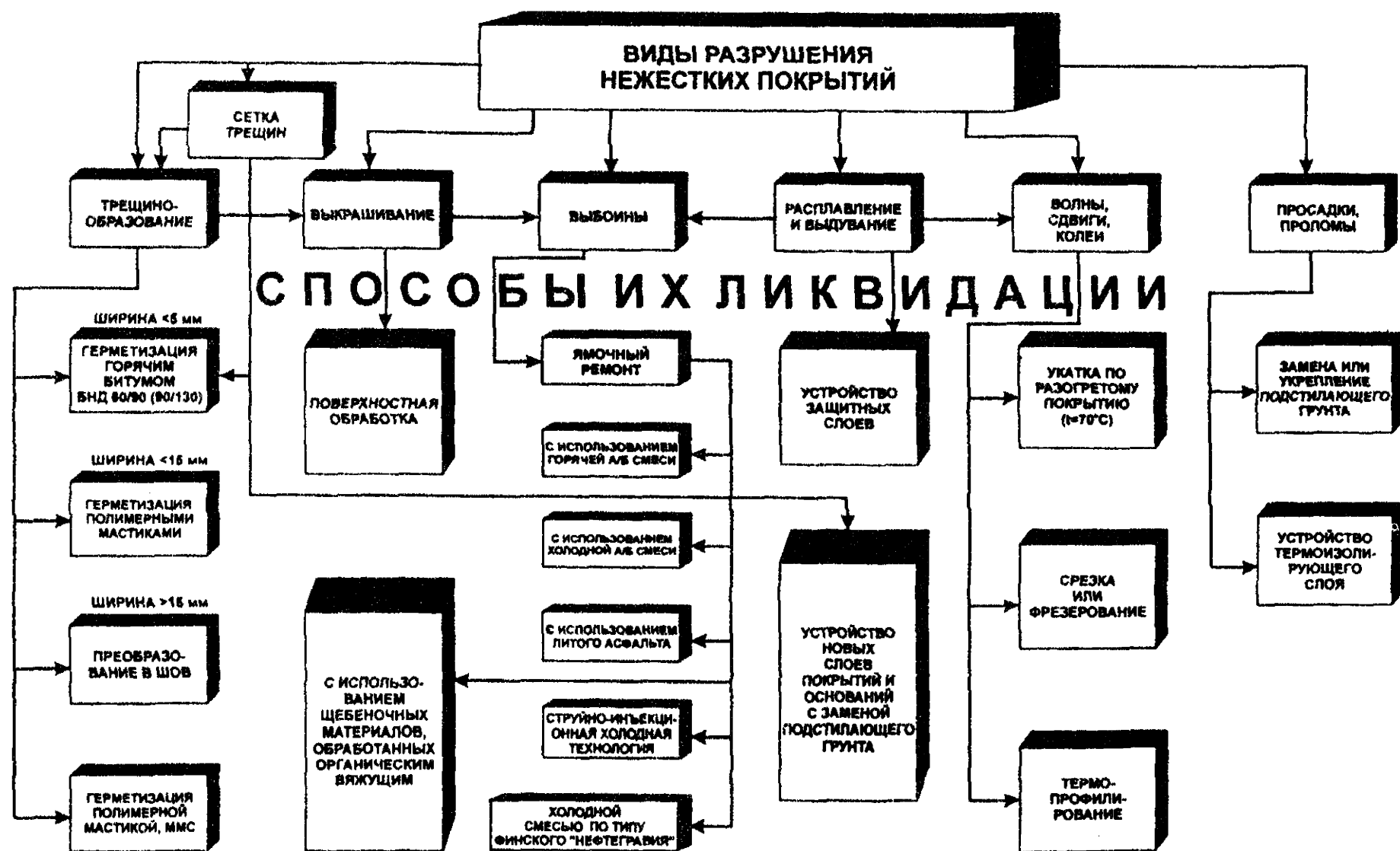
Рис. 3.2. Классификация способов ремонта нежестких покрытий в зависимости от вида разрушения
