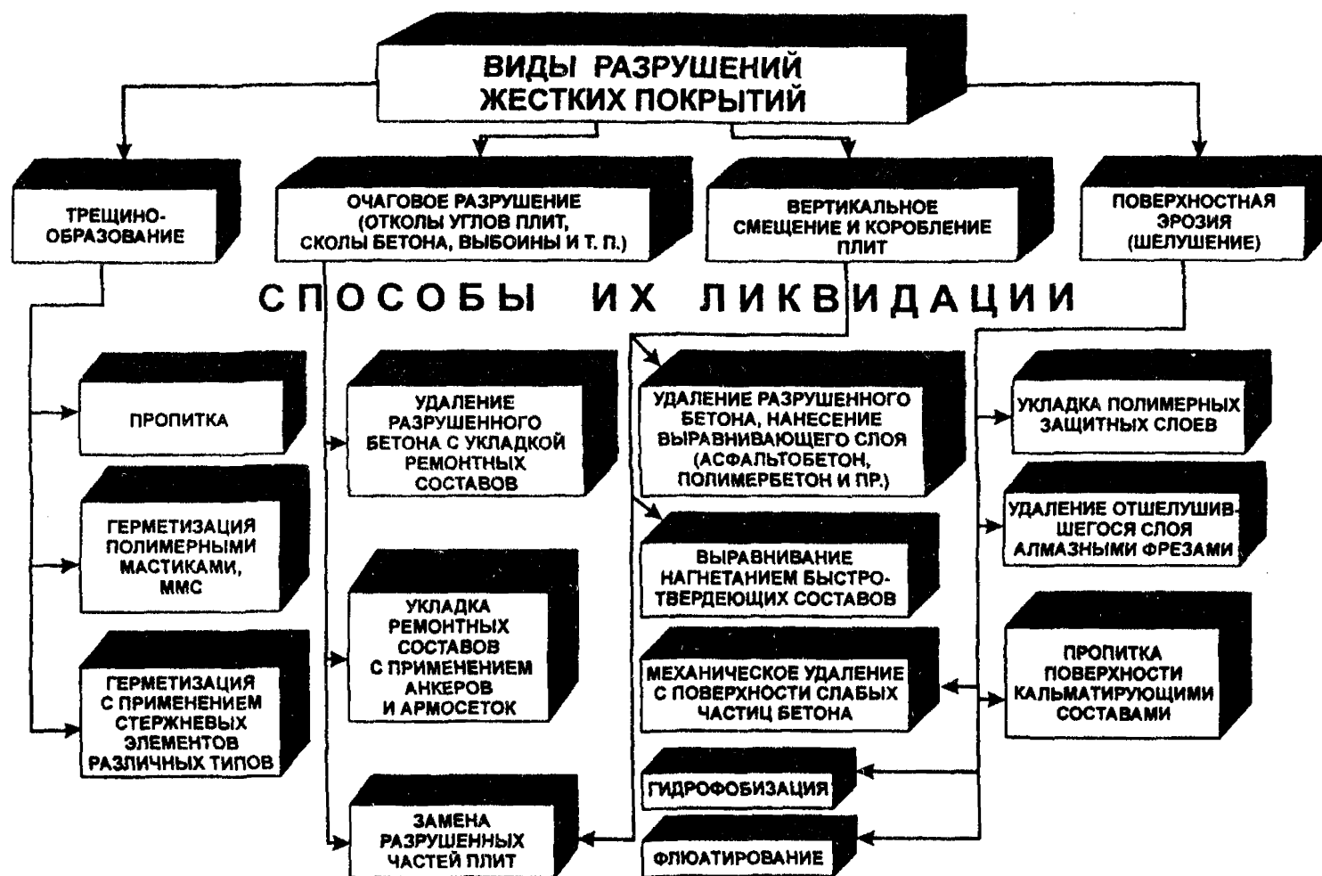
Рис. 3.1. Классификация способов ремонта жестких покрытий в зависимости от вида их разрушения
