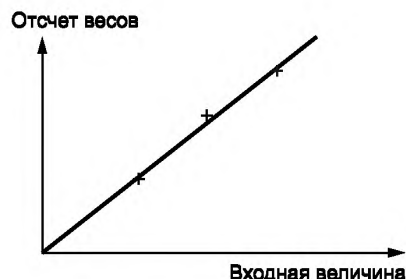
Рисунок 2 — Проверка линейности отсчета весов как функции входной величины
