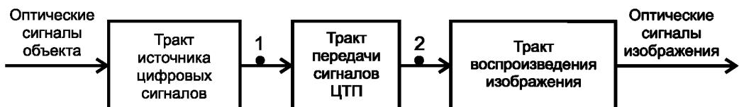
Рисунок 1 — Цифровая система телевидения высокой четкости
