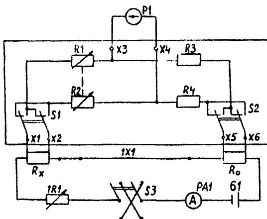
$R_o$  - образцовая мера сопротивления;  $R_x$  - поверяемый шунт;
