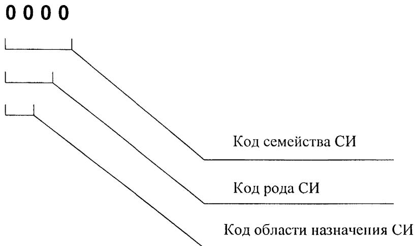
Рис.1 Структура кодов рубрик в систематизации СИ по областям назначения.
