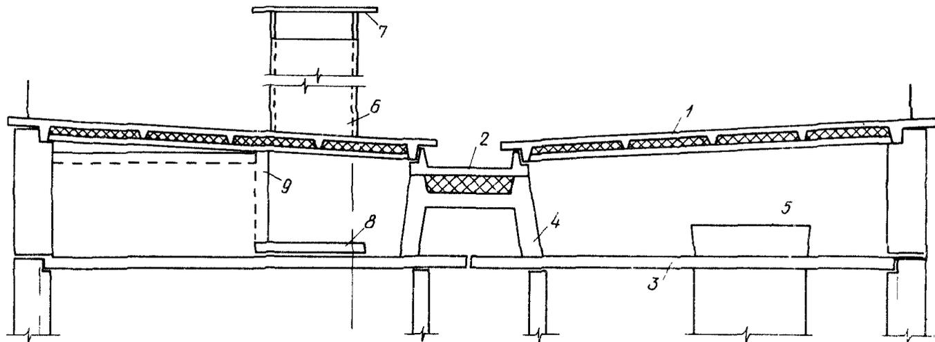
**Рис. 3. Схема лотковой крыши с теплым чердаком**
