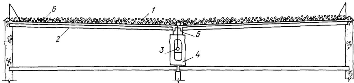
**Рис. 5. Конструкция крыши с теплым чердаком с ковровым покрытием и насыпным утеплителем**
