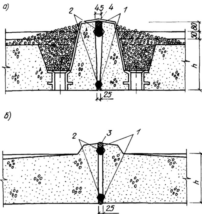
**Рис. 7. Стыки панелей из керамзитогазобетона**
