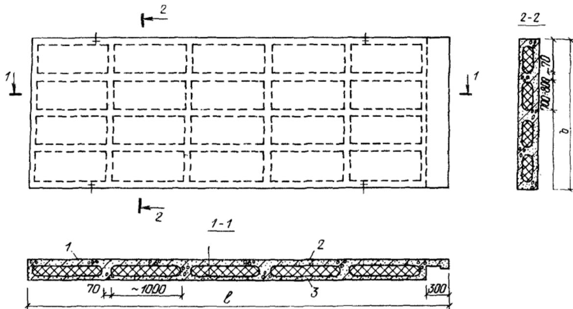
Рис. 11. Комплексная трехслойная панель покрытия с эффективным утеплителем
