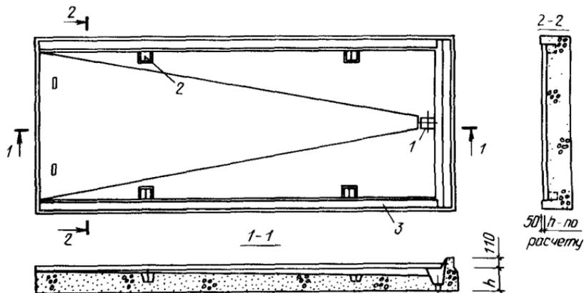
**Рис. 6. Комплексная панель покрытия из разноплотного керамзитогазобетона**
