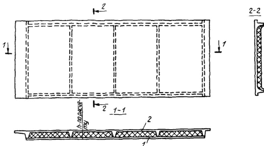
**Рис. 9.** Комплексная двухслойная панель покрытия с эффективным утеплителем
