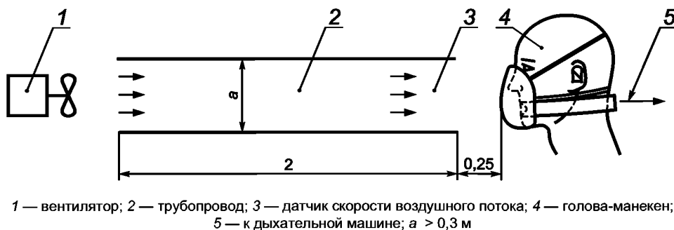
Рисунок 5 — Схема проведения испытания по определению содержания диоксида углерода во вдыхаемом воздухе
