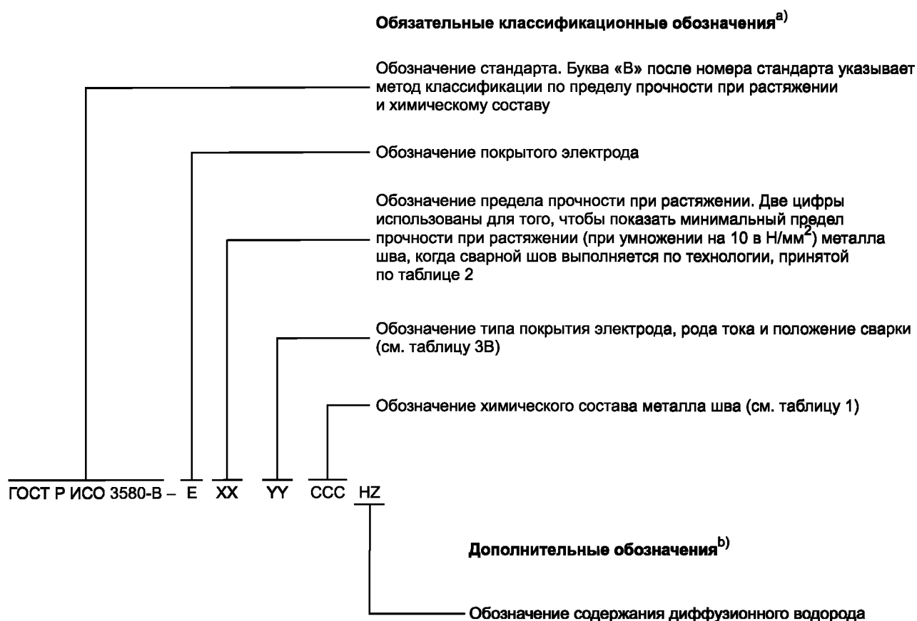
Рисунок A.2 — Метод классификации покрытых электродов по пределу прочности и химическому составу для сварки жаропрочных сталей
