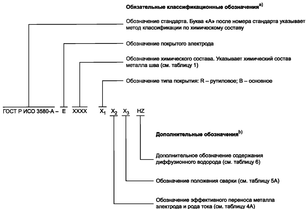
Рисунок А.1 — Метод классификации покрытых электродов по химическому составу для сварки жаропрочных сталей
