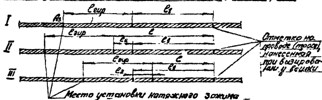
Рис. 37. Нанесение отметок на проводах (тросе) при визировании их без подъема на анкерно-угловую опору
