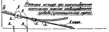
Рис.29. Передача тяжения отбизированного провода (грозозащитного троса) от трактора на якорь а-Первая метка на проводе (тросе); б-Вторая метка на проводе (тросе) на расстоянии, равном \epsilon ;
