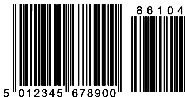
Рисунок 6 — Символ штрихового кода EAN-13 с 5-разрядным дополнительным символом
