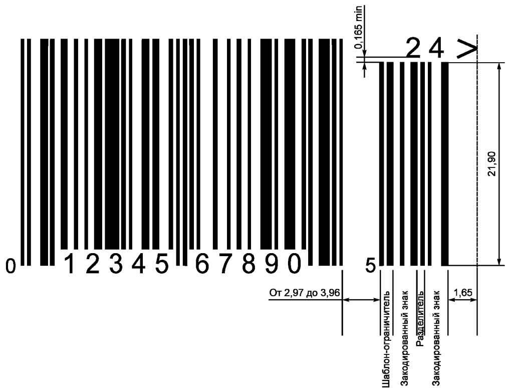
Рисунок E.6 — Символ UPC-A с 2-разрядным дополнительным символом
