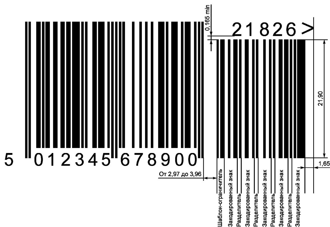
Рисунок Е.7 — Символ EAN-13 с 5-разрядным дополнительным символом
