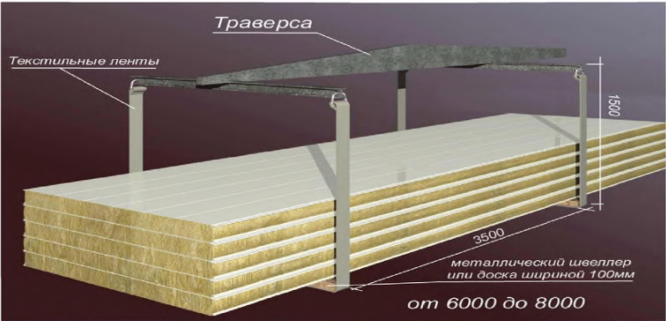
Рисунок 9 – Схема строповки пакетов панелей длиной от 6000 мм до 8000 мм
