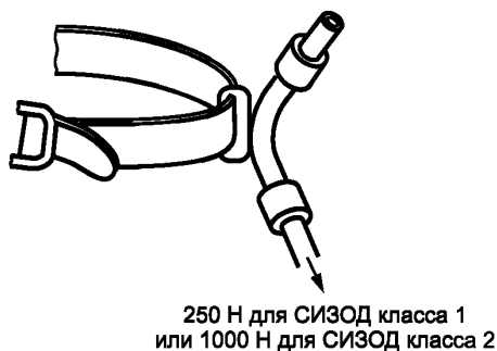
Рисунок 6 — Схема испытания прочности шланга подачи воздуха
