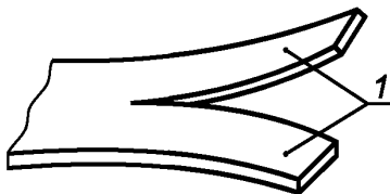
Рисунок 5 — Образец, подготовленный для испытания
