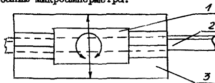
Рис.3. Установка преобразователя на поверхности прокладки
