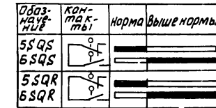
Диаграмма работы конечных выключателей муфты
