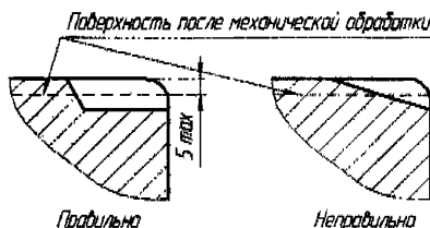
Рисунок 4 – Разделка под заварку дефектов монель-металла
