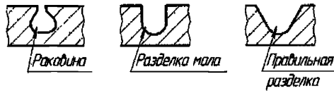
Рисунок 2 – Формы разделки под заварку несквозных дефектов
