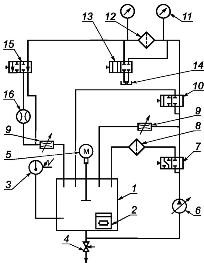
1 — бак с маслом; 2 — электронагреватель; 3 — термометр электроконтактный; 4 — вентиль; 5 — электродвигатель с мешалкой; 6 — насос регулируемый; 7 — клапан включения технологического фильтра; 8 — технологический фильтр; 9 — дроссель регулируемый; 10 — клапан отключения испытуемого фильтра; 11 — манометр; 12 — испытуемый фильтр; 13 — клапан отбора проб; 14 — емкость для отбора проб; 15 — клапан включения расходомера; 16 — расходомер (счетчик жидкости)
