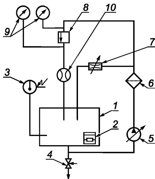
1 — бак с маслом; 2 — электронагреватель; 3 — термометр электроконтактный; 4 — вентиль; 5 — насос регулируемый;
