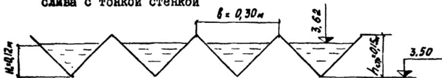
Отметка низа треугольного водослива ( с учетом запаса на неподтопление - 0,05 м)
