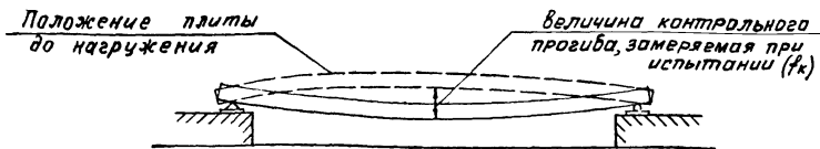
Схема перемещения продольных ребер плиты при загрузении
