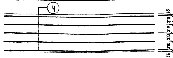
ПЛАН РАЗМЕЩЕНИЯ НАПРЯГАЕМОЙ АРМАТУРЫ В ПАНЕЛЯХ П3-16А; П3-16А; П3-16А; П3-16А.
